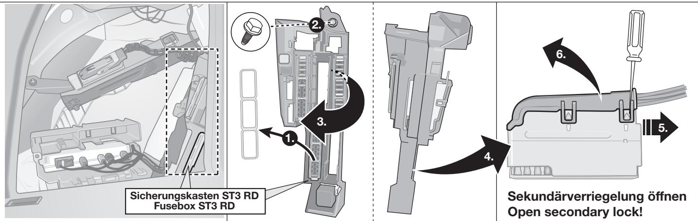
**Sicherungskasten ST3 RD / Fusebox ST3 RD**
