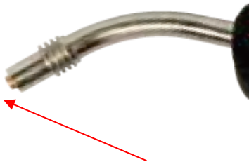
(1) Irrota MIG-polttimeen etuosan osat.
