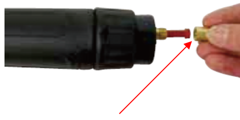
(2) Irrota lankaputken pidätinmutteri.
