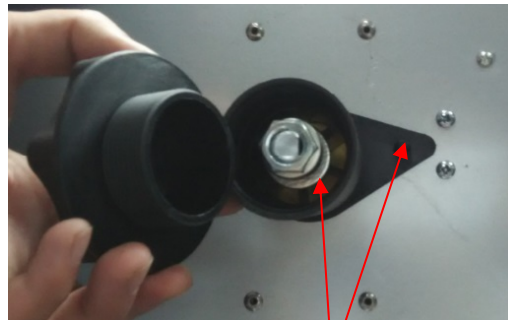
(2) Katso kiristysjousen säätimen ja kelan kohdistustapin sijainti.
