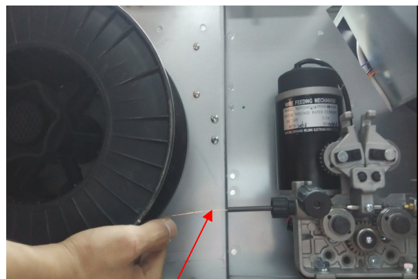
(4) Leikkaa lankaa huolellisesti ja pidä langasta kiinni, jota se ei purkautu kelalta. Syötä lankaa varovasti langansyöttölaitteen sisääntulon ohjausputkeen.
