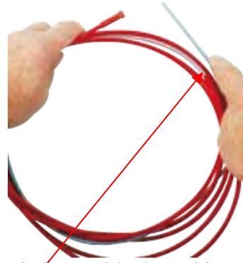
(4) Aukaise uusi lankaputki varovasti.
