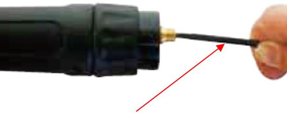
(5) Syötä uusi lankaputki varovasti polttimen johtoon asti niin että se tulee ulos polttimen kaulasta. Varo taittamasta lankaputkea mutkalle.
