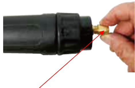
(6) Asenna lankaputken pidätinmutteri ja ruuvaa vain 1/2 kierrosta.
