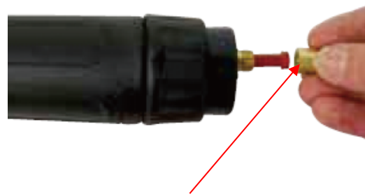
(2) Irrota lankaputken pidätinmutteri.
