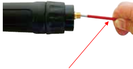
(2) Irrota lankaputken pidätinmutteri.
